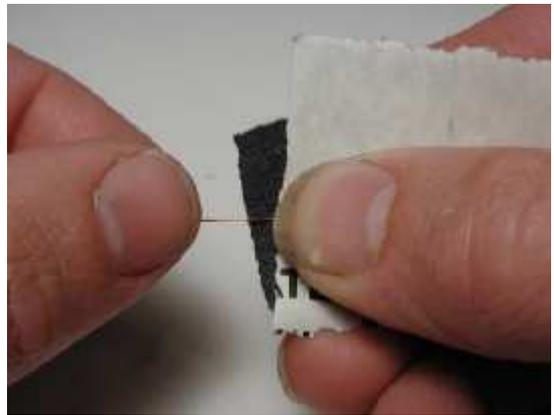
7. Testare le bobine per assicurarsi che l'elettricità possa passare attraverso di esse: settare il voltmetro (200 ohm di range) e connettere il cavo di prova alla parte terminale delle bobine.
