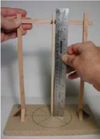
12. Fissare la barra trasversale con la colla calda.
