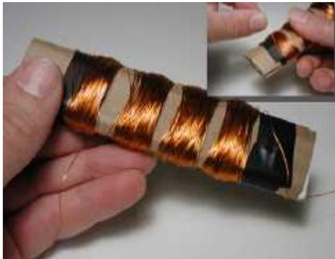
4. Far scorrere il primo avvolgimento lungo il supporto di cartone e fissarlo con 2 degli 8 pezzi di nastro isolante.
