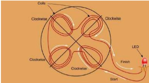
2. Una volta che si è sicuri che le bobine siano propriamente posizionate, incollarle sul disco statore. Le bobine dovrebbero toccare la circonferenza che è stata disegnata sulla base. Utilizzare un'abbondante quantità di colla sotto ogni bobina.
