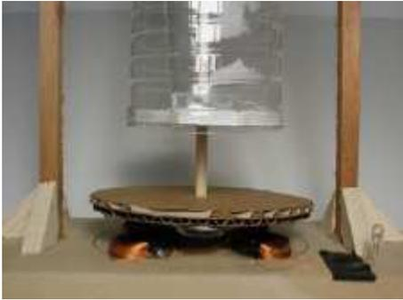
3. Mettere colla calda sul disco rotore e l'albero in modo che non possa muoversi.
