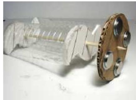
2. Adattare la turbina/rotore assemblati nel passo precedente nella struttura di legno già realizzata. Far scorrere la parte superiore dell'albero attraverso la vite ad occhio e posizionare la parte affilata nella vite. Far girare il rotore ed assicurarsi che:
