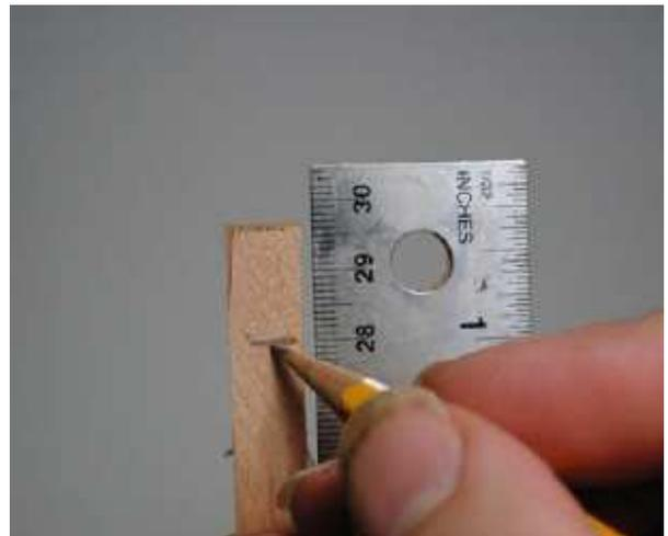
11. Far scorrere l'asticella attraverso la vite ad occhiello sul montante trasversale; posizionare il montante trasversale sui montanti verticali in maniera tale che l'asticella sia perpendicolare alla base. Contrassegnare la sua posizione con la matita.
