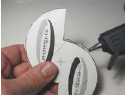
7. Dopo aver verificato la tenuta, applicare la colla calda sul bordo della seconda sagoma della turbina e fissarla sulla stessa metà della bottiglia, sul lato opposto.
