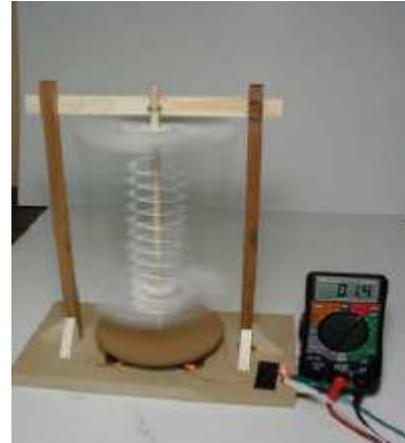
3. Soffiare sulla turbina per farla girare. Si dovrebbero ottenere almeno 1 volt e al massimo 4 volts.
